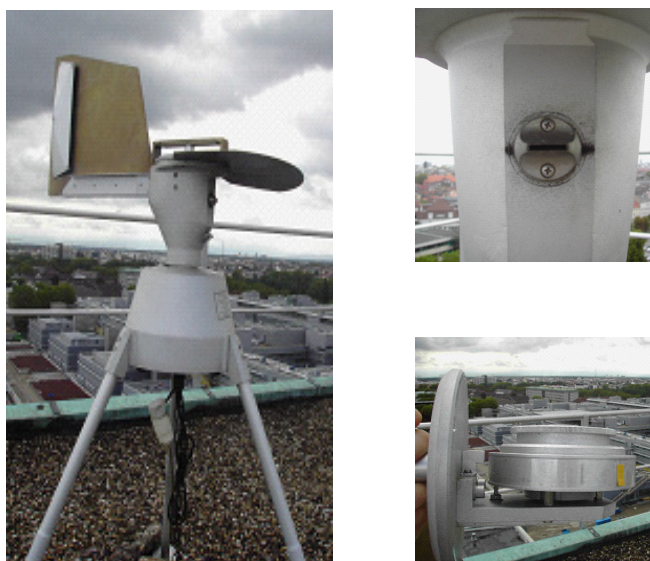
Figure 3 – Photographie d'un capteur volumétrique de pollen de type Hirst avec détails de la buse d'aspiration et du tambour (source L. Bonhême)
